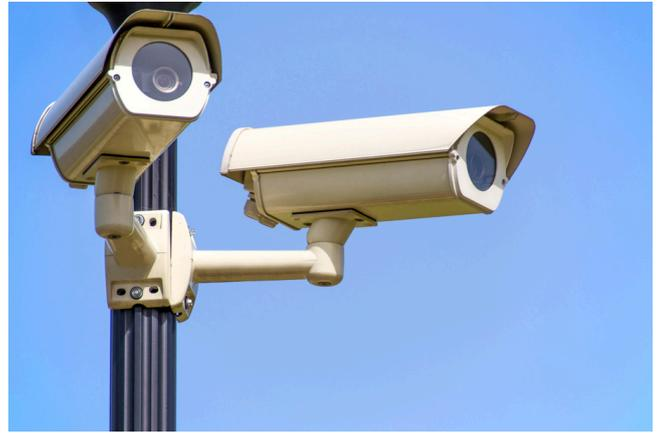
Les caméras seront soit simples et uni-directionnelles pour permettre nuit et jour la lecture des plaques minéralogiques ; soit multidirectionnelles pour permettre le suivi des mouvements des véhicules et des personnes. Les images générées par ces caméras seront enregistrées et permettront de vérifier les présences sur le domaine public en cas d'incident signalé.
